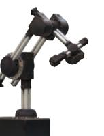
由工程塑料直驱齿轮组成的机器人
