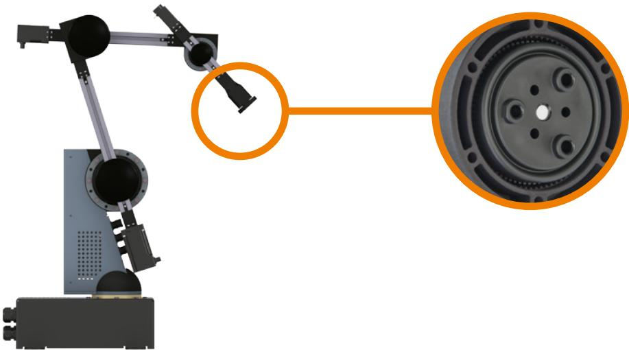
带涡轮和諧波齿轮的robolink® SQ 和 DQ robolink® SQ and DQ with worm and strainwave gear
