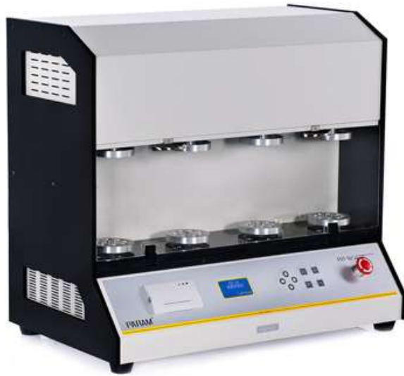
图 2 FDT-02 揉搓试验机
